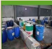
危险废物之间由于化学性质等不同，须用隔板隔离，避免发生化学反应。
